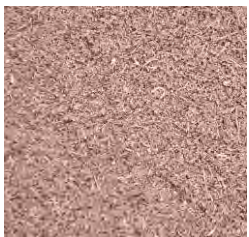
HMV-Schlackeaufbereitung, Schwerfraktion aus NE-Gemisch, Quelle: Breer
