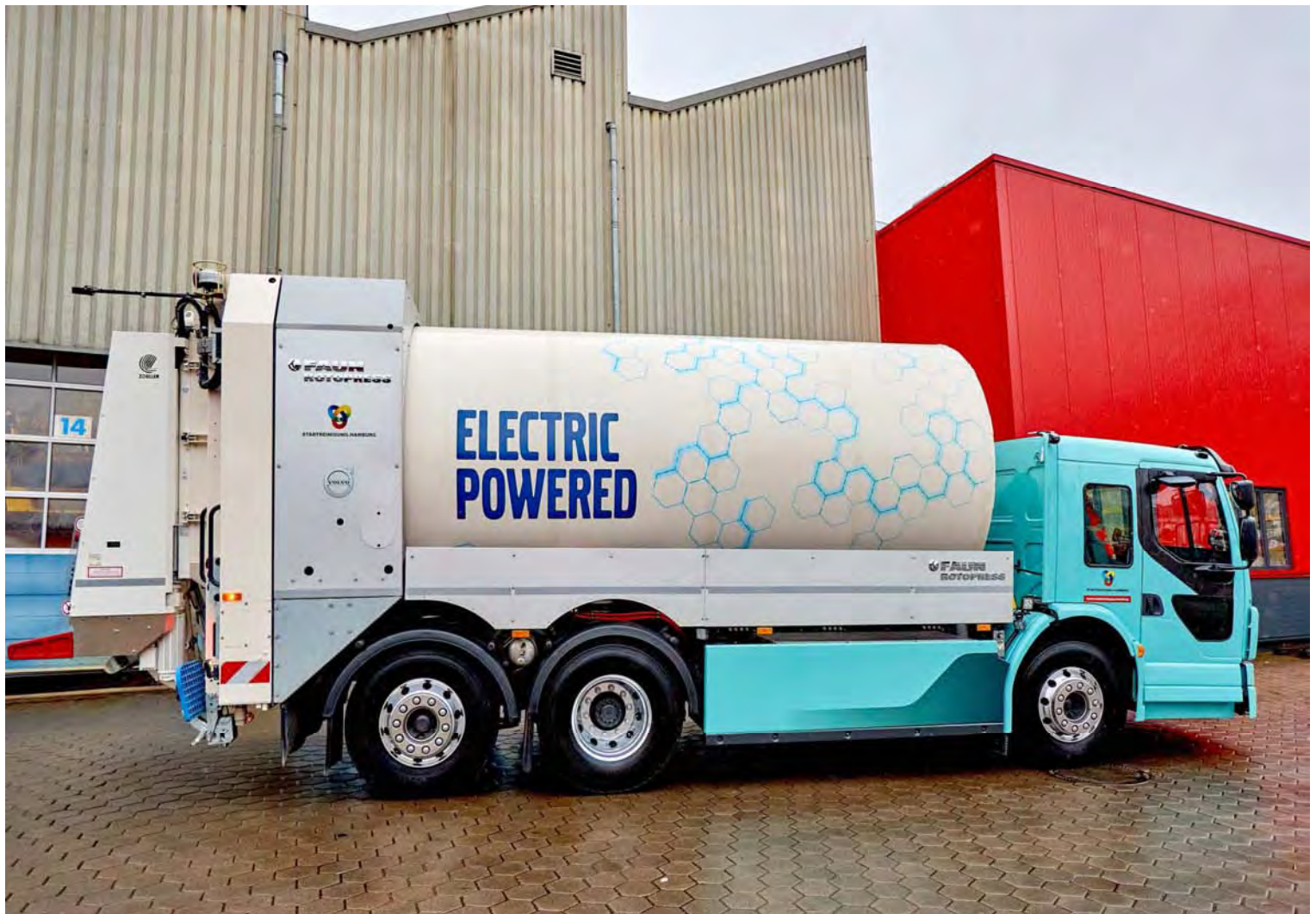
Vollelektrischer Müllwagen mit Volvo-Fahrgestell und FAUN-Aufbau, Quelle: Stadtreinigung Hamburg,
