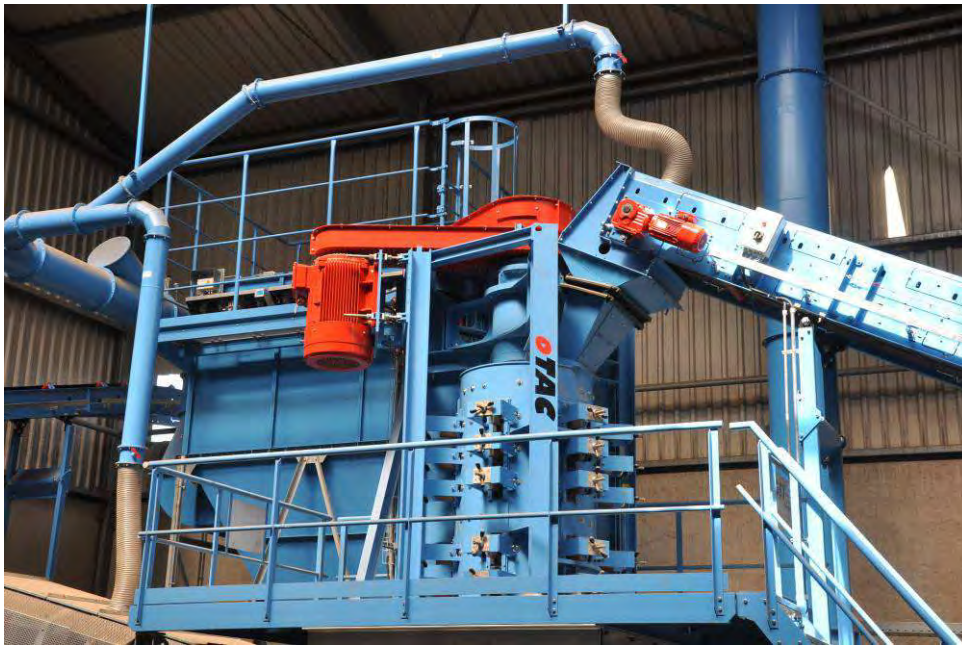
Hochgeschwindigkeits- prallverkleinerer, Quelle: Breer
